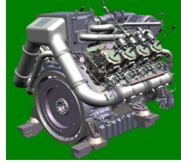
Şekil 4. TÜBİTAK-RUTE tarafından geliştirilen 8 silindirli, 788 BG hidrojen/amonyak motoru
