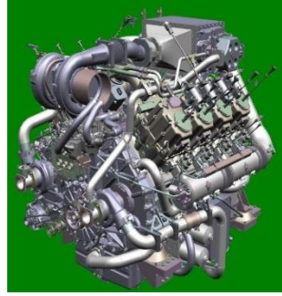
Şekil 4. TÜBİTAK-RUTE tarafından geliştirilen 8 silindirli, 788 BG hidrojen/amonyak motoru
