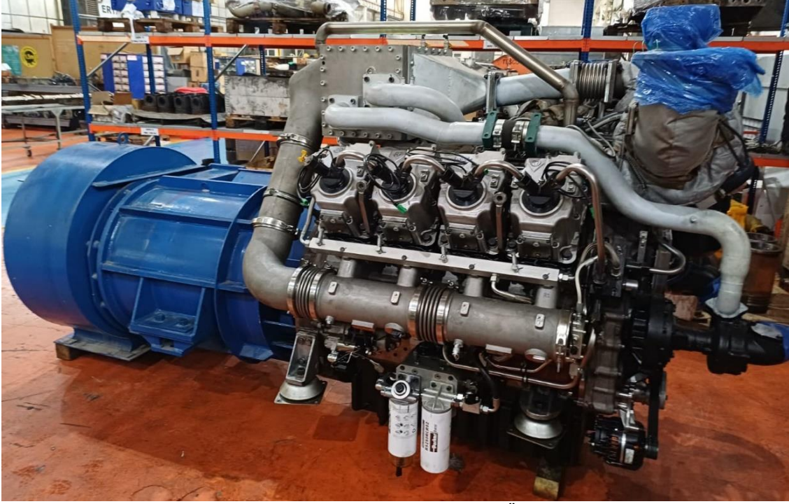
Şekil 2. DE11000 tipi manevra lokomotifine monte edilmek üzere TÜRESAŞ'a teslim edilen milli genset
