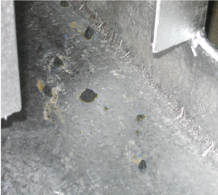
Resim 16 - Dros Ve Kül Kaplanmış Yüzeyler
