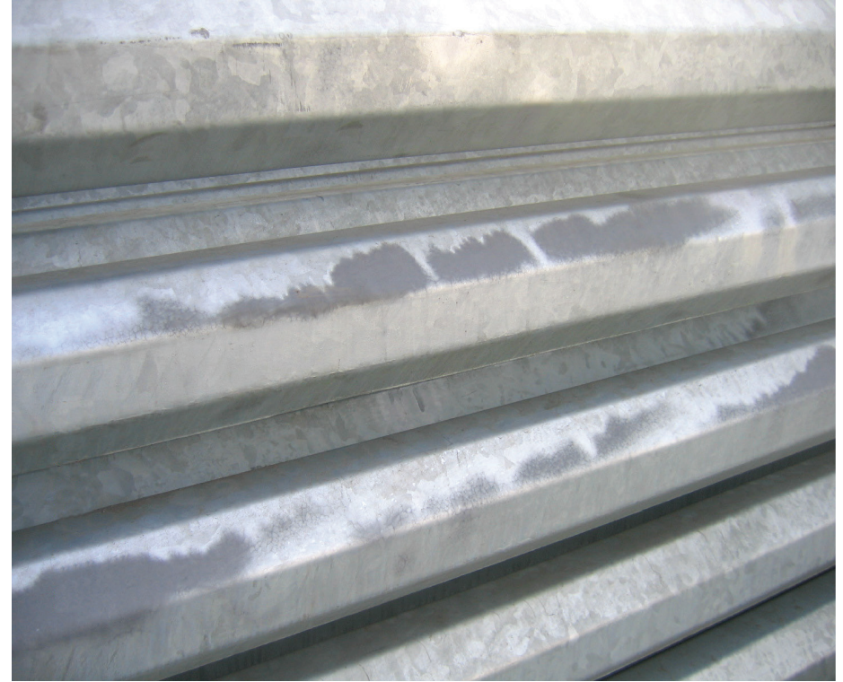
Resim 8 - Mat Renkli Galvanizli Yüzeyler
