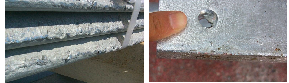
Resim 14 - Kenarlarda ve deliklerde galvaniz birikintileri
