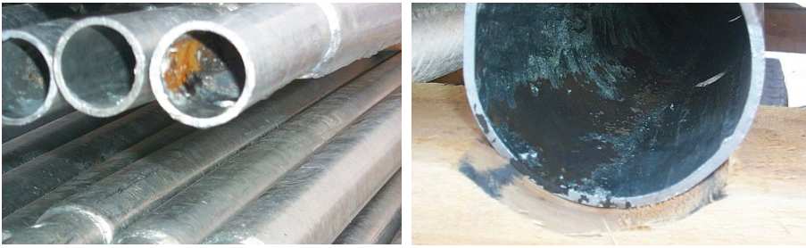
Resim 12 - Borularda kaplanmamış bölgeler
