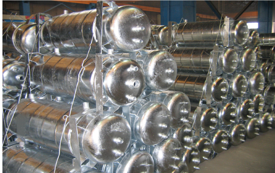
Resim 4 - Silindirik Kapların Galvaniz Kaplaması
