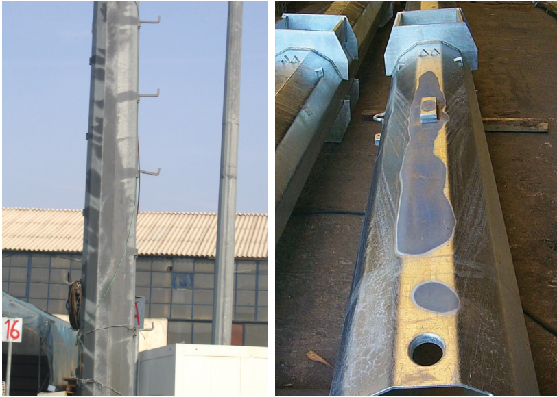
Resim 7 - Mat Renkli Galvaniz Yüzeyi
