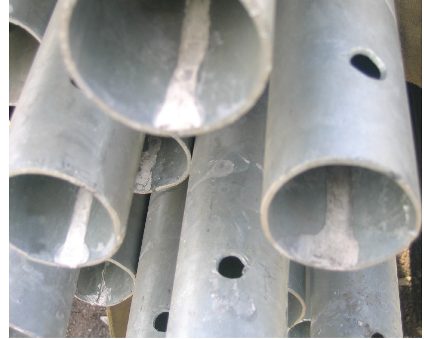
Resim 17 - Borularda Beyaz Pas
