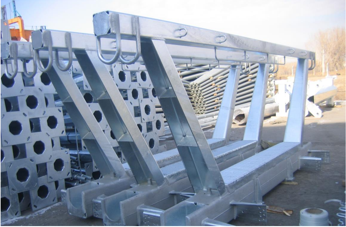
Resim 5 - Teleferik Direk Sapanı Galvaniz Kaplaması
