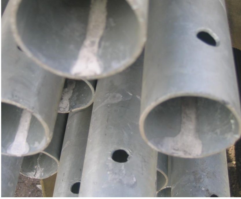
Resim 17 - Borularda Beyaz Pas
