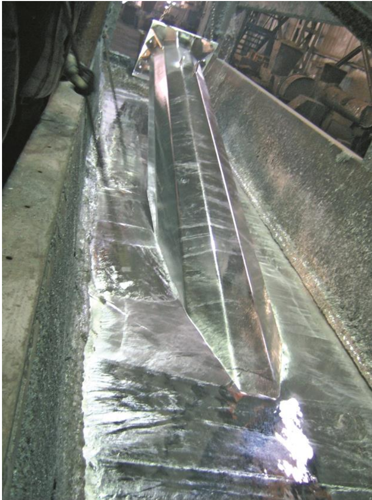
Resim 6 - Poligon Direğin Galvaniz Banyosundan Çıkarılışı
