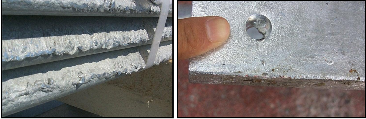
Resim 14 - Kenarlarda ve deliklerde galvaniz birikintileri
