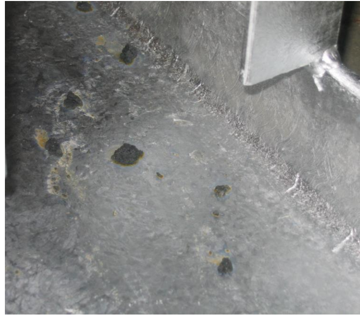
Resim 16 - Dros Ve Kül Kaplanmış Yüzeyler
