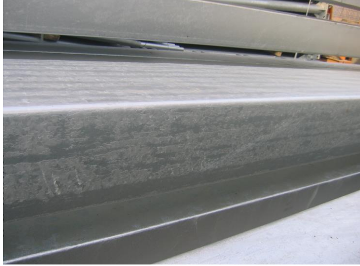
Resim 9 - Galvanizden sonra Fil Derisi Pürüzlü Yüzey
