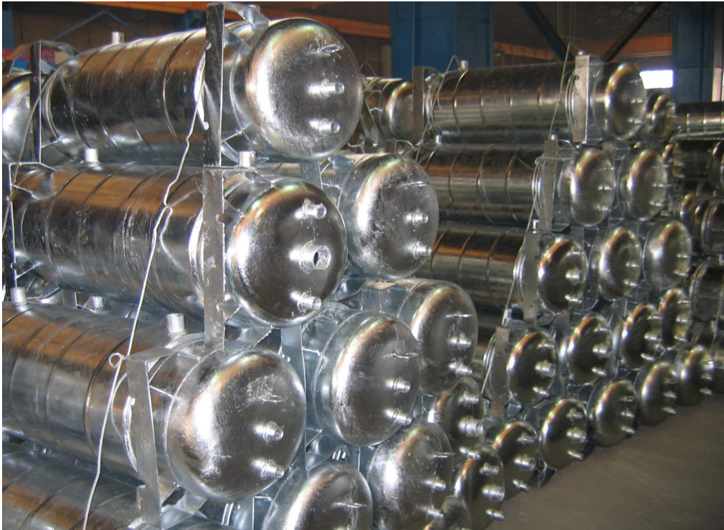
Resim 4 - Silindirik Kapların Galvaniz Kaplaması
